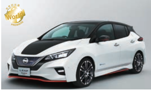
LEAF NISMO Concept 通过采用专用外观设计,不会使空气阻力系数Cd值加大,从而降低了提升量,其采用的专用悬架、高性能轮胎、专用调节电脑(VCM)也值得注目。 LEAF NISMO Concept 전용 외관 채용으로 키드를 수치를 악화시키는 일 없이 리프트 양을 저감, 전용 서스펜션과 고정승 타이머, 전용 튜닝 컴퓨터(VCM)도 주목할 만하다.
