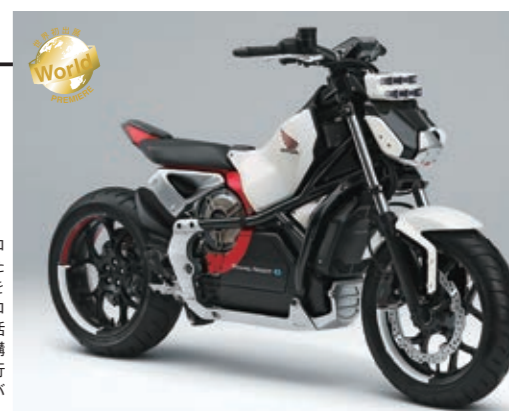
Riding Assist-e ヒューマノイドロボット研究で培ったバランス制御技術を活用した実験車。ロボティクス技術を活用したアシスト機構により、極低速走行時にマシン自体がバランスを保つ
