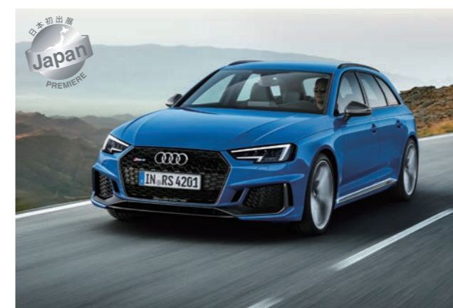
Audi RS 4 Avant。駆動方式はAWDのquattro(4輪駆動)。変速機は8速ディブトロニックを採用
