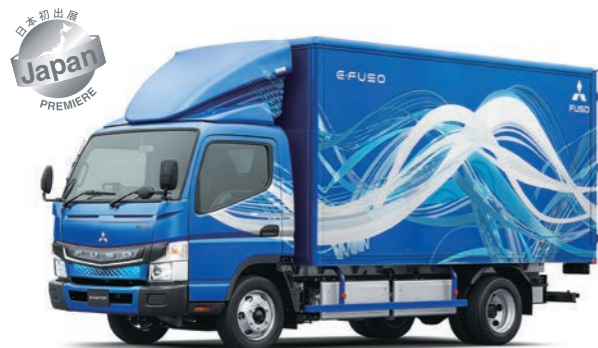
アンダーフレームにバッテリーを確認できるeCanter。東京モーターショーでは日本向けの右ハンドル仕様が公開される
