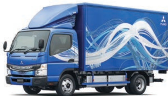
eCanter 三菱ふそうは世界初の量産電気小型トラック「eCanter」を展示。オール電気駆動なのでクリーンな排ガス、さらにエンジンノイズもゼロ
