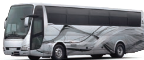
Aero Ace こちらは「小排気量・低燃費エンジン」「新型8速AMT・Shift Pilot」「ABA3をはじめとするトータルセーフティ」などを搭載する大型バスの最新モデル
