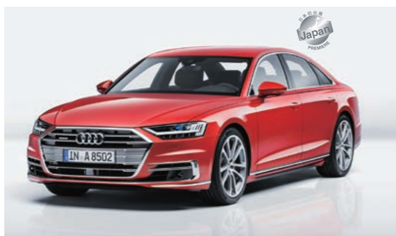
A8 自動運転「レベル3」のアウディ AIトラフィックジャムパイロット搭載。「レベル2」と違い、ドライバーは継続的にクルマの状況を監視する必要がない
