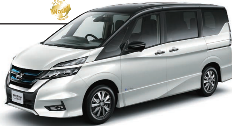
SERENA e-POWER モーターが駆動しエンジンは発電専用となる新型のハイブリッドシステムを搭載。これにより高い燃費性能を発揮する
