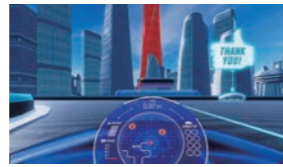
車間通信で、死角の車両を知らせて自動で減速
