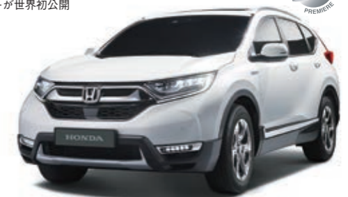
CR-V 5代目CR-Vは2モーターハイブリッドシステムの「SPORT HYBRID i-MMD」を採用。ホイールベースとトレッドも広げ、SUVとしての車格感を強調
