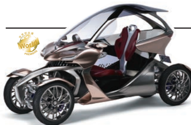
MWC-4 “ハーフサイズモビリティ”がコンセプトの4輪LMW。従来の二輪車にはない快適性と、発電用エンジンを備えたモータードライブが大きな特徴
