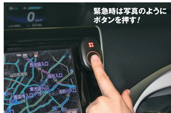
『つながるボタン』は天地約53mm×左右約37mmで、センターコンソール、ナビ画面横、ハンドル横などに装着。専用アプリと連動することで、緊急時のヘルプ、通常時の運転診断など、非常に貴重な機能を持っているいわば“安心のボタン”だ
