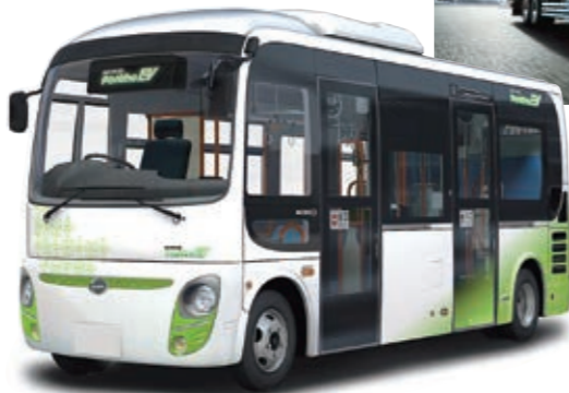
PONCHO EV 国内で唯一の小型ノンステップバス「日野ポンチョ」のディーゼルエンジンを電気モーターに置き換えたEVバス。既に一部地域で営業運行を行っている
