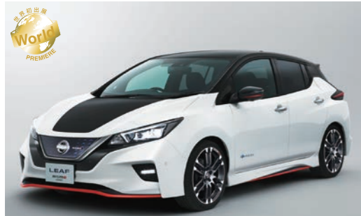
LEAF NISMO Concept 専用エクステリア採用により、Cd値を悪化させることなくリフト量を低減。専用サスや高性能タイヤ、専用チューニングコンピュータ (VCM) にも注目を
