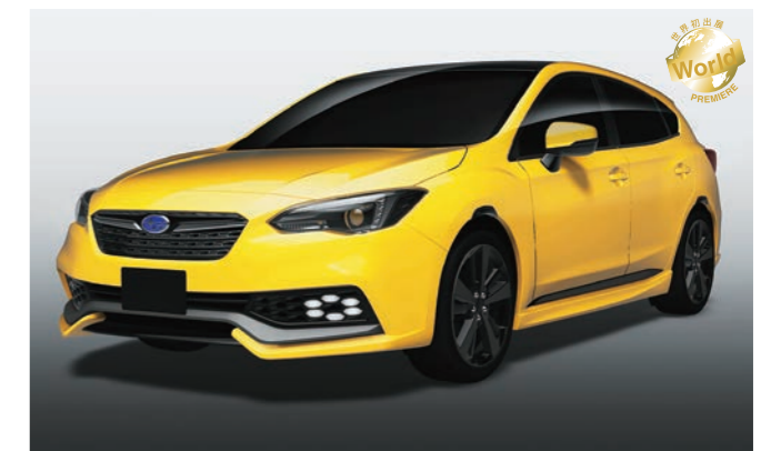
IMPREZA FUTURE SPORT CONCEPT インプレッサスポーツをベースに作られたデザインコンセプトモデル。低重心な形状の前後バンパーと、存在感たっぷりなセンターマフラーに注目
